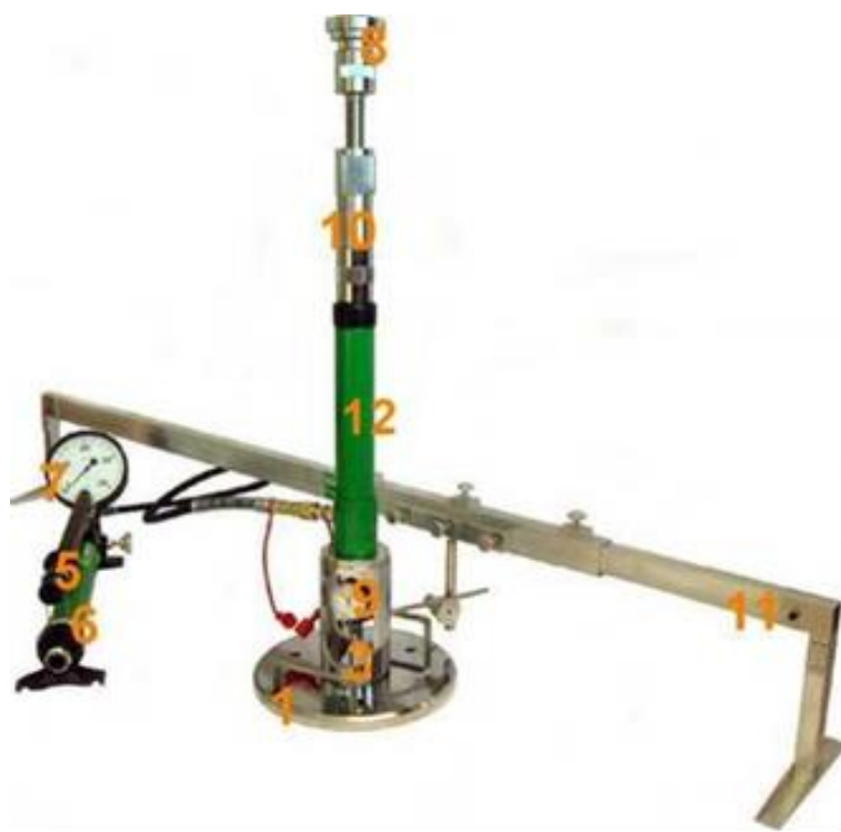
Rys. 1.2 Aparatura VSS z jednopunktowym pomiarem przemieszczenia płyty
